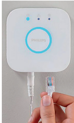
De Philips Hue Bridge slaat een brug tussen je lokale netwerk en ZigBee
